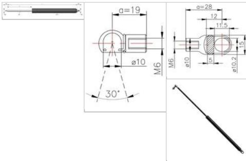
Gasdruckfeder für die Heckscheibe (3221531R1)
