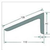
Hinterrad Kotflügel- Verbreiterung
