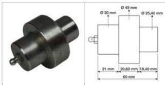
Lagerbolzen Allradachse (3147233R1)
