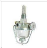
Tankhahn mit Sedimentfilter (632948M92)
