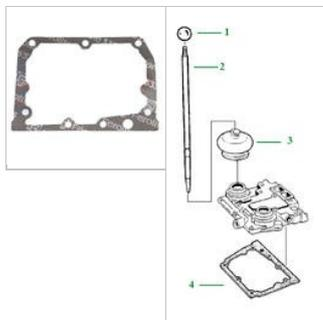
Dichtung für Schalthebeldeckel (R54189)
