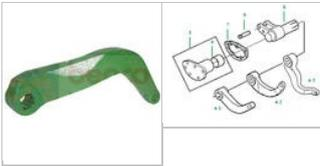
Lenkhebel / Lenkram am Lenkgetriebe (L33213, L37327, L42080)
