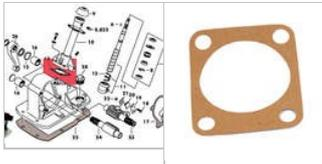
Dichtung für das Lenkspindelgehäuse
