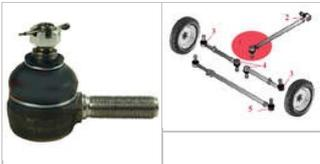
Kugelkopf / Spurstangenkopf (3040922R92, 3045309R91)
