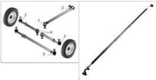
Lenkschubstange mit 2 Kugelköpfen (3058842R94)
