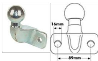
Kugelkopf - Anschraubversion mit einem 50mm Kugelkopf, der Lochabstand der Bohrungen im Flansch ist 89mm. Der Durchmesser der Bohrung beträgt 16mm.
