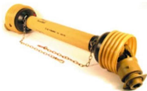
**Gelenkwelle 710mm mit Freilaufkupplung / Profil 1 3/8" 6 Z / - linkslauf Frontanbau / baugleich Walterscheid W2400**
