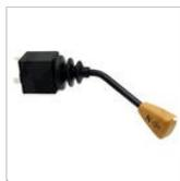
Fahrtrichtungsschalter an der Lenksäule (87535666)
