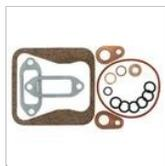
Dichtsatz oben, Kopfdichtungssatz (03305749)
