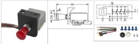
Zweikreis, spritzwassergeschützt, für Fahrzeuge mit 12 V-Anlage, Zugschalter, roter Schaltknopf als Kontroll-Leuchte ausgebildet, mit Halter und eingebautem Leitungssatz 600 mm lang, mit eingebauter 12 V-Glühlampe
