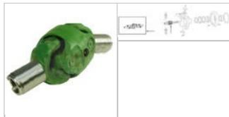
Kreuzgelenk / Doppelgelenkwelle 4WD Allradachse, komplett
