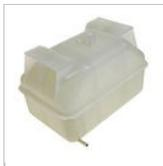
Ausgleichbehälter für Kühler / Kühlwasserbehälter / Kühlmittel-Vorratsbehälter (5128791)
