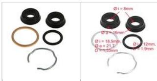
Dichtsatz für den Hauptbremszylinder (04372222)
