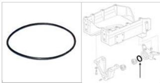
Dichtring für die Vorderachse (3010428X1)
