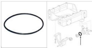
Dichtring für die Vorderachse (365801X1)
