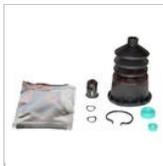
Reparatursatz für Hauptbremszylinder (1810936M91)
