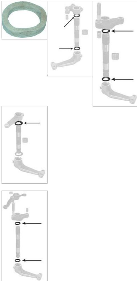
Dichtung für Lenkwelle (196079M1)
